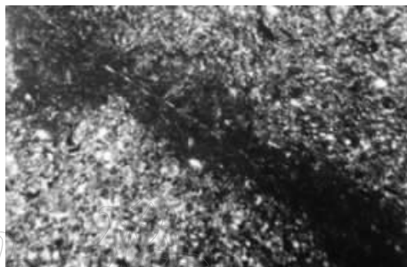
图 4 池 48 号孔断层物质显微照片 (40 倍, 正交偏光)
