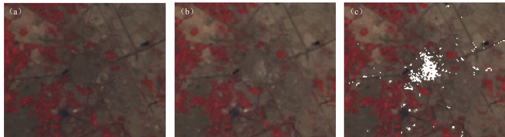
图 8 安贾尔市震前(a)、震后(b)TM 图像及震害信息提取结果(c),白色斑点区域即为震害区域
