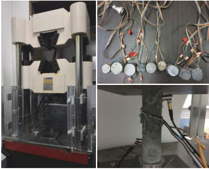
图 2 单轴压缩试验照片 Fig. 2 Photos of uniaxial compression experiment
