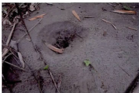
图 3 喷砂孔的最大孔径(灰绿色的砂土)
