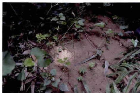
图 4 喷砂孔喷出的灰黄色砂土
