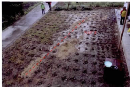
图 12 喷砂孔成串珠状分布(西南侧)
