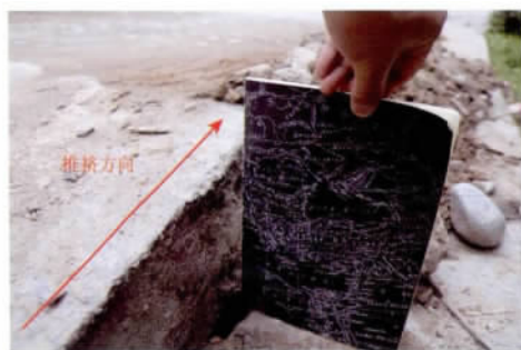
图 7 地表变形最大高度约 20 cm
