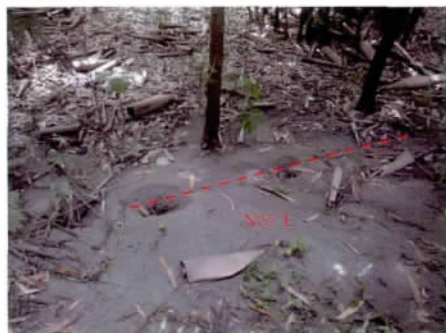
图 11 喷砂孔成串珠状分布(西北侧)
