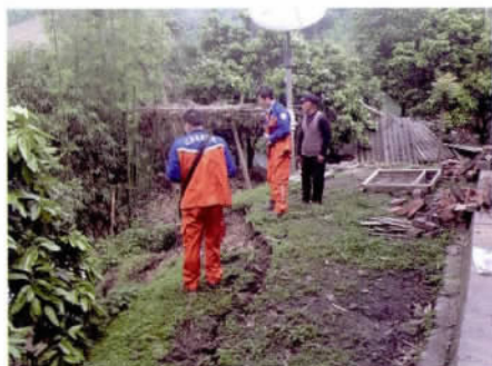
图 5 农村民居周边坡体弧形地裂缝
