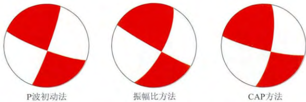
图 6 永宁 M_s4.6 地震震源机制解不同方法的结果对比
