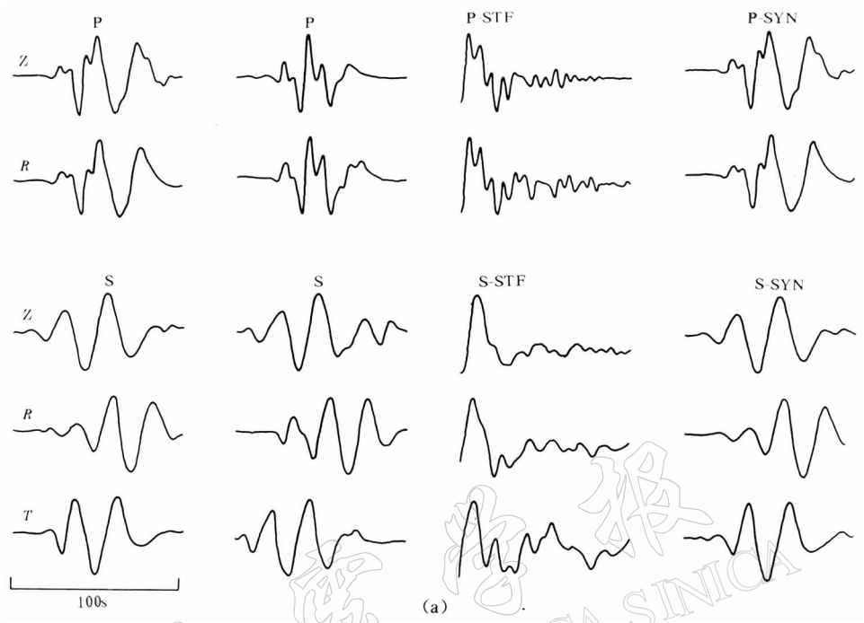
图 2 (a) 从 HYB 台的 P 和 S 波震相提取震源时间函数的过程
